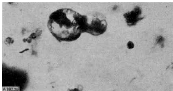
Bild 20 Kieselglaseinschlüsse mit Silicaten im Innern der Einschlüsse, beim Zusammenfließen erstarrt. (500 : 1). Analyse: vgl. Bild 19
